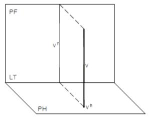
La vraie grandeur d'une droite se situe dans le plan PF et dans le plan PH.
