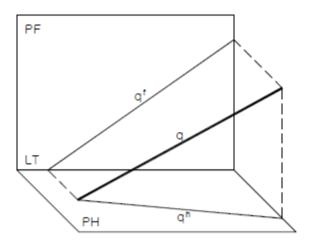
q<sup>f</sup> est la projection de la droite q sur le plan frontale PF q<sup>h</sup> est la projection de la droite q sur le plan horizontale PH
